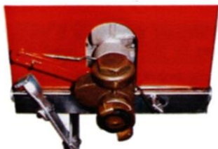
Snabbavstängningsventilen i stängt läge
