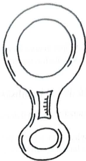
Figur 10: Firmingsåtta, bör inte användas till säkring.
