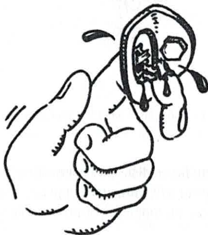
Figur 22: Bulthängare kan ha vassa kanter och ska därför inte användas som grepp.
